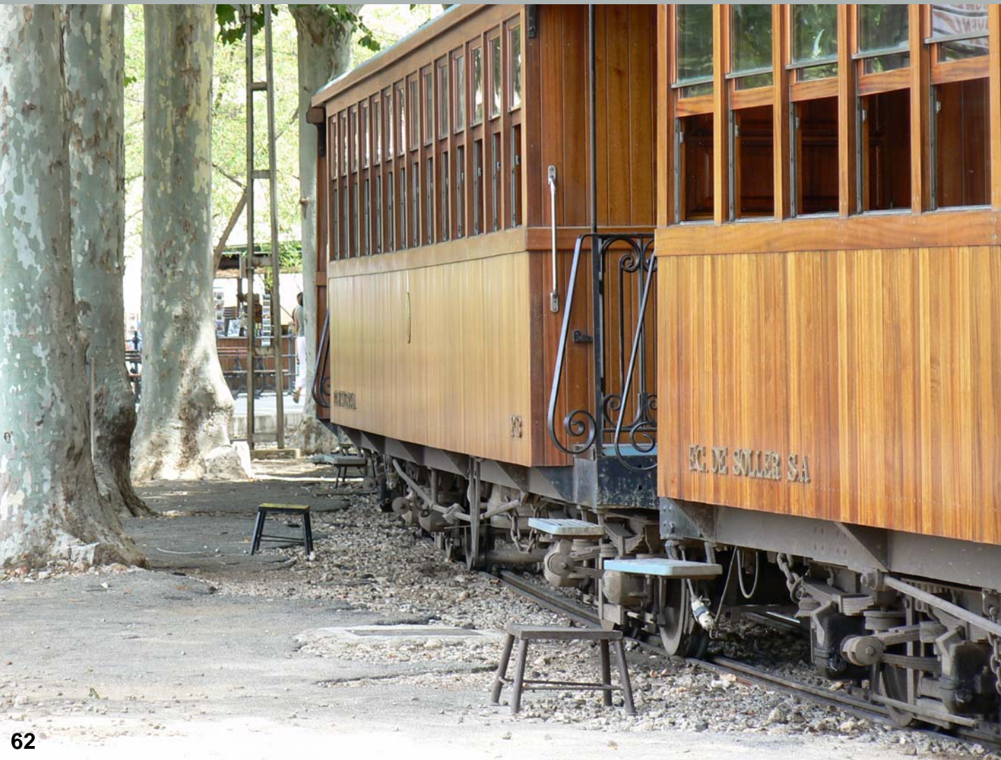
Bild 62: Wenn der Zug nicht am Bahnsteig bestiegen werden kann, kommen wieder die Einstieghilfen zum Einsatz.
